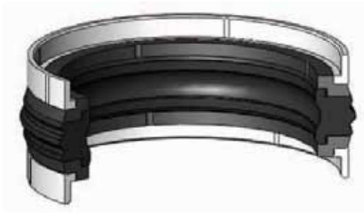
K18是五件套的雙向組合封，由一個丁腈橡膠密封環、兩個用來防止密封間隙擠出的聚氨酯彈性體和兩個熱塑性塑料的導向環組成。
